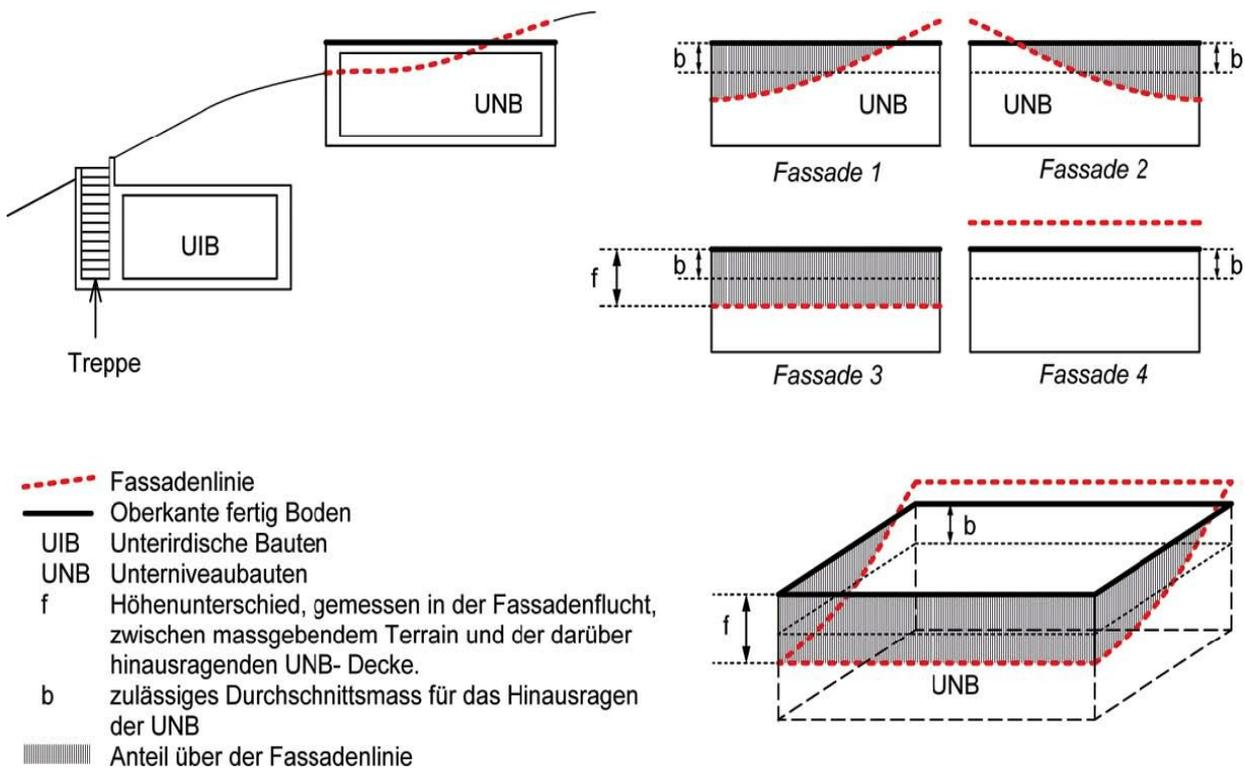
Skizze zu 2.4 unterirdische Baute und 2.5 Unterniveaubaute
